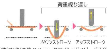
※測定条件: 変位 3.0mm クロスヘッドスピード 1.0mm/min
