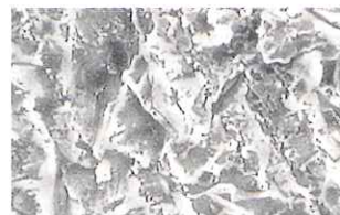
サンドブラスト処理した金属面 金属面全体に接着面積が約2倍に増大し 微小機械的保持力のある表面ができ、接 着力が向上します。
