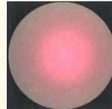
光拡散性が高いCR (レーザー光がぼやけて、周りになじんでいる)
