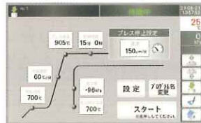
わかりやすい日本語表示のタッチパネルを採用したことにより工程管理がわかりやすく、焼成中のプログラムの変更など操作が簡便に行えます。
